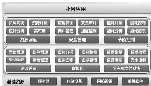
图 2 云计算基础体系架构逻辑模型
