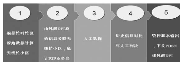
图 3 小区动态拥塞管控流程
