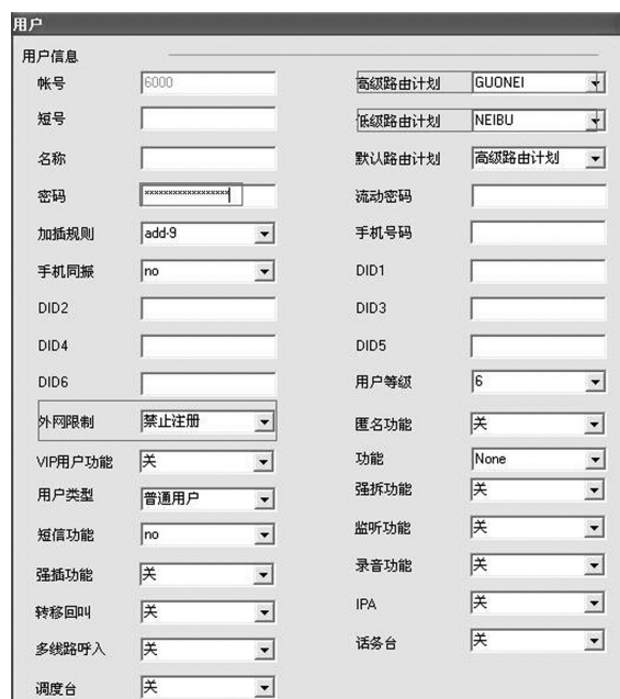
图 5 设备侧配置图
